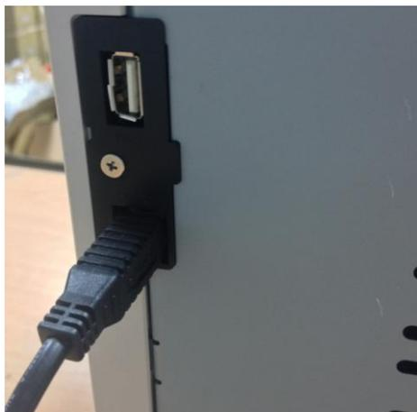
4.2 将 USB 连线插入印表机背面左侧的 USB 孔，并确认是否插紧
