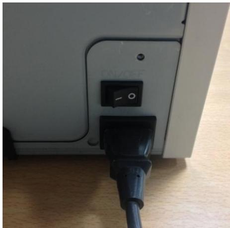
4.1 请将配件盒附带的电源线插入到打印机背面的电源连接器中
